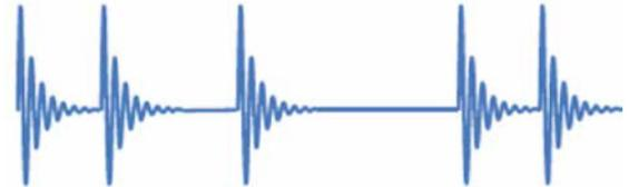
*Il segnale utilizzato da tutte le unità Hydropath ha una forma ben definita e facilmente riconoscibile, benché l'ampiezza e lo spettro varino a seconda della particolare applicazione.*
