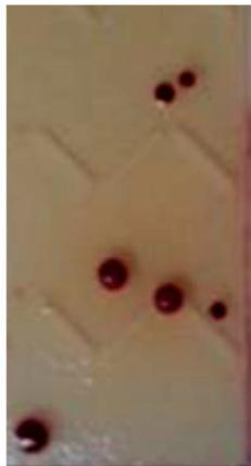
Dopo 1.5 mesi con biocida ridotto del 50% (tra 1,000 e 5,000 UFC) Leggero aumento della conta UFC poiché HydroFLOW ha iniziato a rimuovere il biofilm dalla torre evaporativa.
